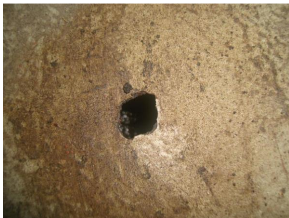
Сквозное отверстие в днище
